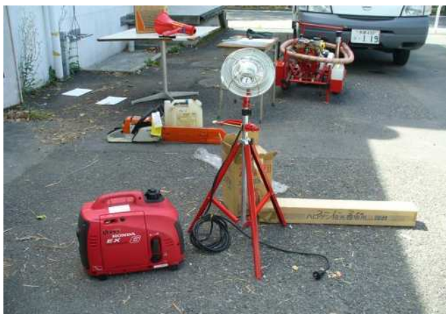
(7) 発電機・投光器（三脚付き）
